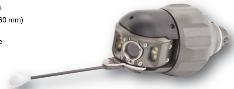
Con la speciale asta PIN è possibile guidare la telecamera satellite KS 60 CL nell'ispezione di allacciamenti ramificati. La rappresentazione grafica delle condotte ispezionate avviene mediante il modulo di navigazione (opzionale) del software PipeCommander.
